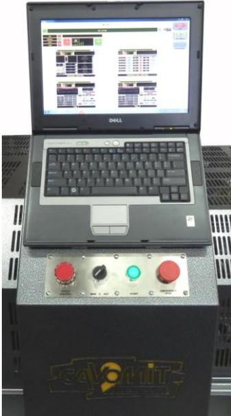
Makinaya monte edilen sistem sıcak baskı varak yıldız ve Hologram baskısı yapabilmektedir **Holo Cylinder** baskı sistemi standar (2) elektronik stepper motorla imal ediliyor fakat isteğe göre (4) elektronik stepper motorla imal edilebilir ve bu sistem **Heidelberg 46X58,5 tan 64X90** a kadar monte edilir aynı sistem **Johannisberg 73X104** makinayada monte edilir.
